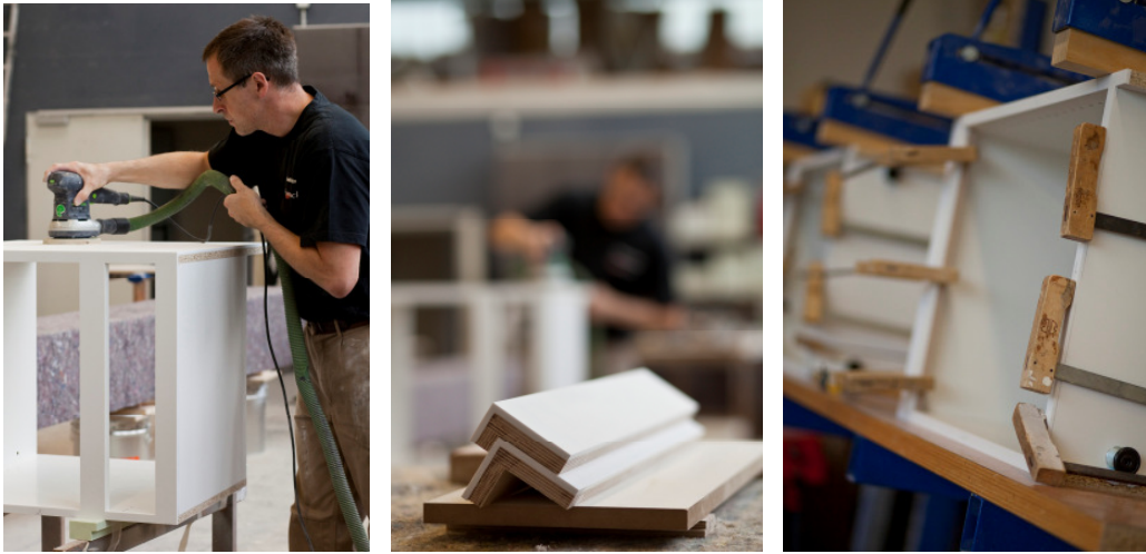
Blick in die Werkstatt der Tischlerei formsache: Alltag mit DuPont™ Corian® - Schneiden, Fräsen, Verkleben, Schleifen, Polieren. Dank seiner optisch fugenlosen Verarbeitung eignet sich das homogene Material für komplexe Formen. Alle Fotos: Eckhard Rahaus
